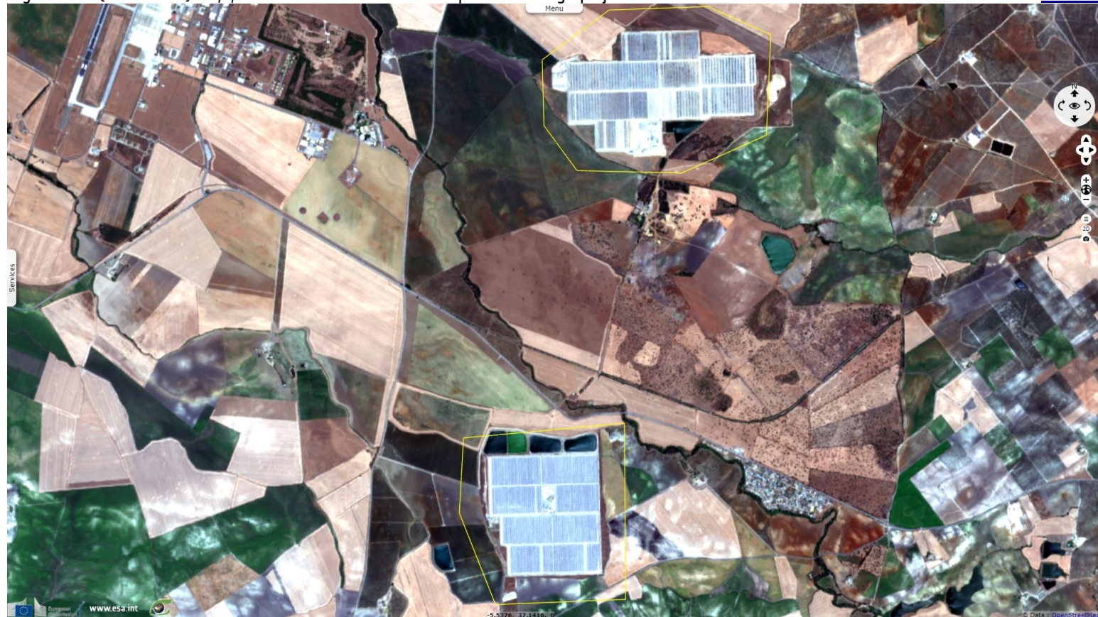
Fig. 13 - S2 (11.06.2019) - 4,3,2 natural colour - Two 50 MW parabolic trough projects in Morón de la Frontera Aranales
